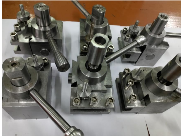
Ồ dao tháo lắp nhanh trên máy tiện, phay vụn năng
